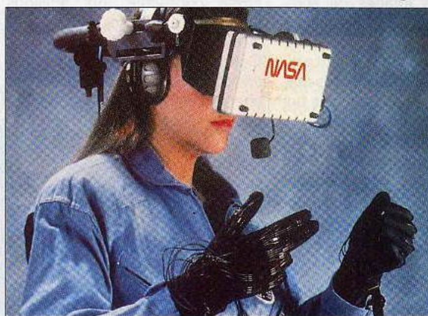
Détail du système : un écran placé devant les yeux, des gants numériques, un casque sur les oreilles et un micro...
