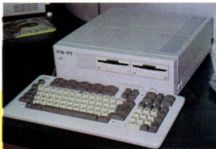
Le FM 77 de Fujitsu est le frère du FM 7 : il intègre deux lecteurs de disquettes au format Sony.
