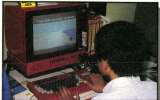
Avec General, MSX est intégré dans le boîtier de la télévision. Sur le côté droit de celle-ci, la cartouche enfichable de jeu.
