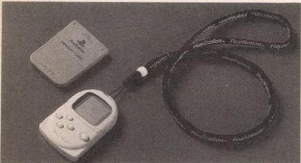
ソニー・コンピュータエンタテインメント (SCE) という、プレイステーションで有名な企業。そのSCEが、一風変わったPDAを開発した。このPDA、なんと、プレイステーションのメモリーカードに32ビットRISC CPUと液晶・サウンド機能などを取り付けてしまったものなのだ。もちろん、プレステのメモリーカードとしても利用できる。今冬発売予定をめぐしている。
