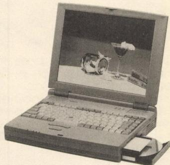
東芝からフロッピーディスクとCD-ROMを本体に同時内蔵し、CPUにMMX-Pentium 166MHz、12.1インチTFTカラー液晶、2.1GBハードディスクを搭載したオールインワンノートパソコン「DynaBook Satellite 300」が発売。
