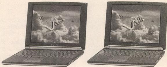
筐体にマグネシウム合金を採用し、B5ファイルサイズとして世界最薄の厚さ23.9mm、質量約1.35kgの薄型・軽量を実現して、一躍超人気ノートパソコンになった「VAIO PCG-505」の後継機種「PCG-505EX」「PCG-505X」がソニーから発売されたぞ。
