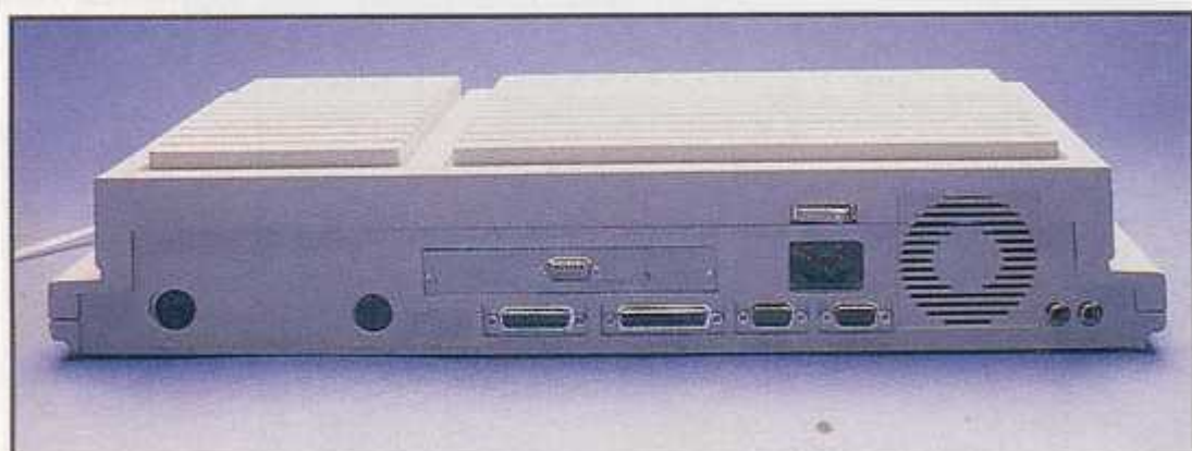
De gauche à droite, le port lecteur externe, l'interface moniteur, les sorties disque dur et imprimante et trois sorties série !
