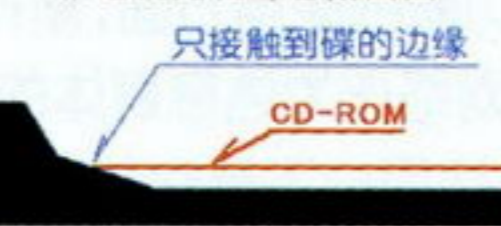
一般电脑光驱碟仓剖面图
