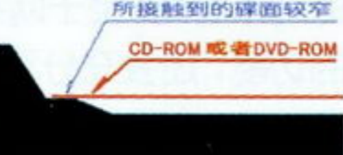
PS2 光驱碟仓剖面图
