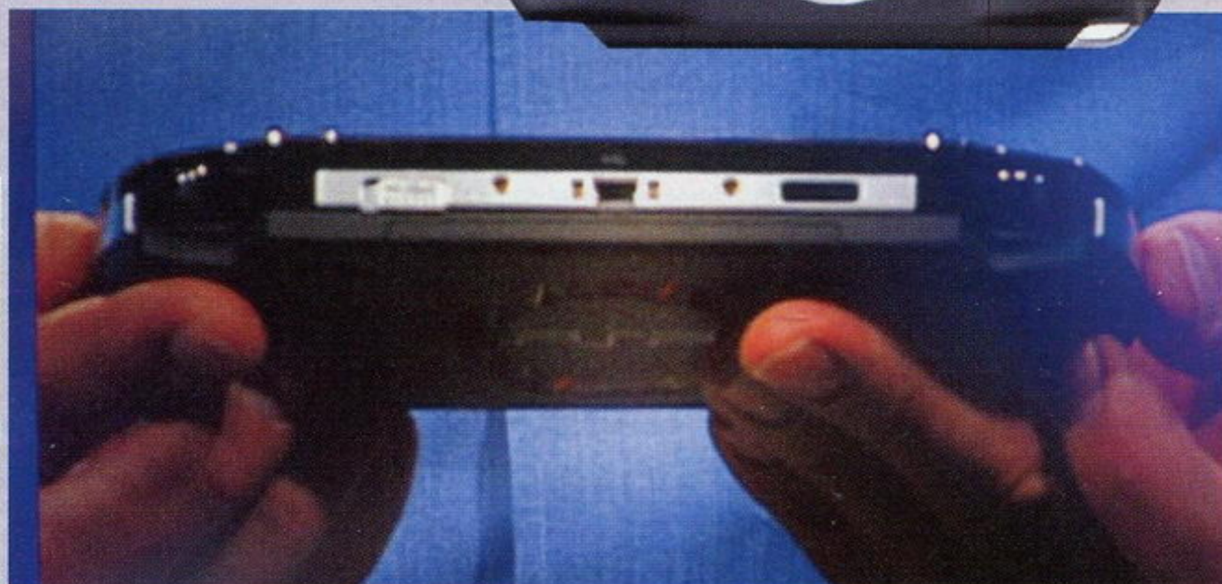
▲在主机的顶部可看到中央的USB 2.0端口,端口右边那个孔应该是固定USB周边用的,端口左边是开启碟仓的滑动开关。
