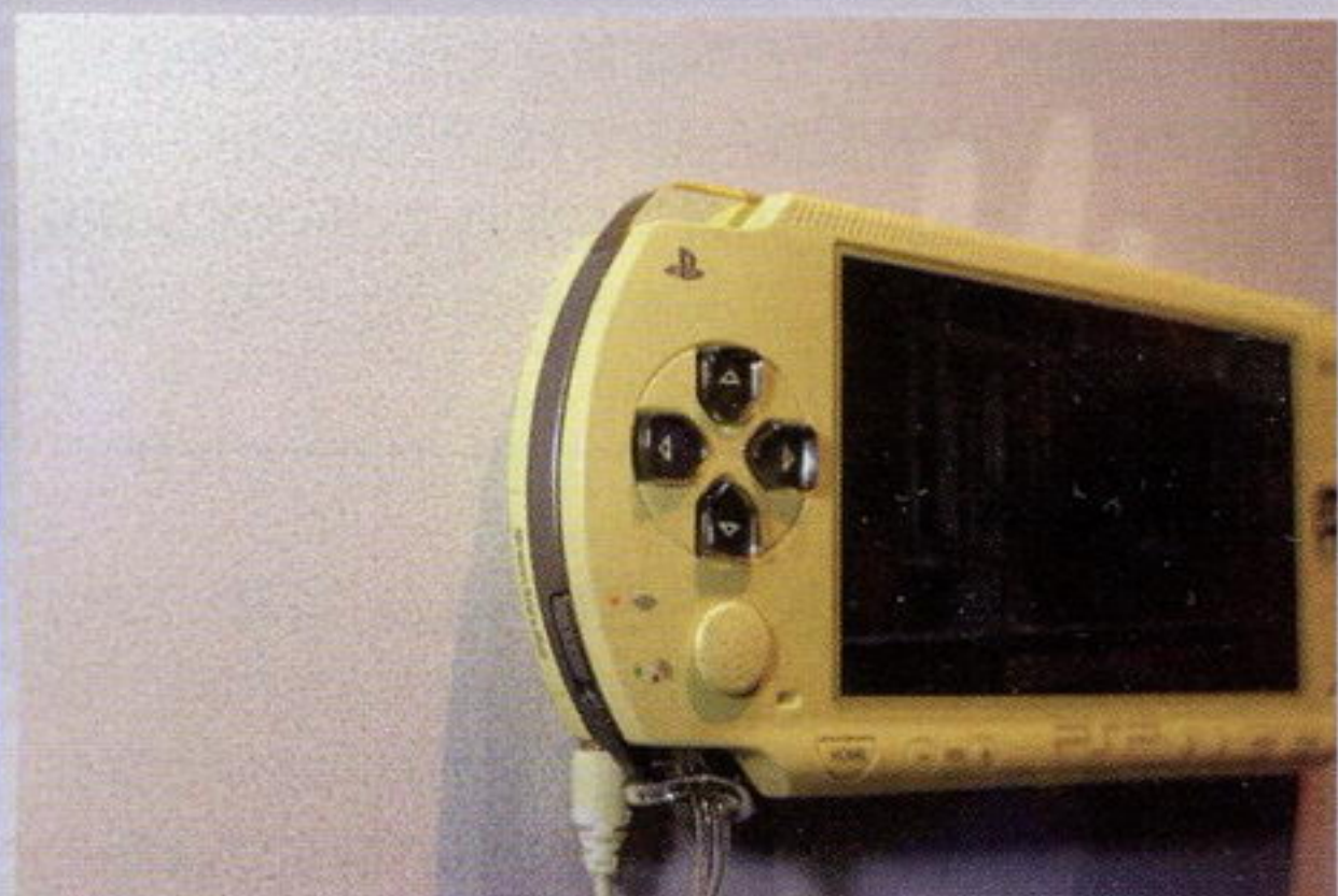
▲PSP支持索尼的记忆棒Memroy Stick DUO,记忆棒的插槽在主机左侧部,可以看到插槽处“Memroy Stick DUO”的字样。另外无线通信功能的开关也处于左侧部,开启或者关闭时不同的指示灯会亮起。从这个画面也能看到立体声耳机的插孔处于主机底部的最左边,靠近系挂绳的地方。
