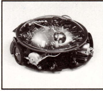
MEMOCOM CRAWLER MV-918 Questo robot è controllato da una memoria RAM 256x4 bit, mediante la tastiera inclusa nel kit e si muove in base ai comandi comunicati a quest'ultima. L.149.000
