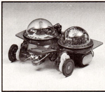
NAVIUS MV-938 È un robot controllato mediante dischetti programmabili. È in grado di riconoscere il bianco e il nero del dischetto programmato e quindi muoversi in avanti, a destra, a sinistra o fermarsi. L.115.000
