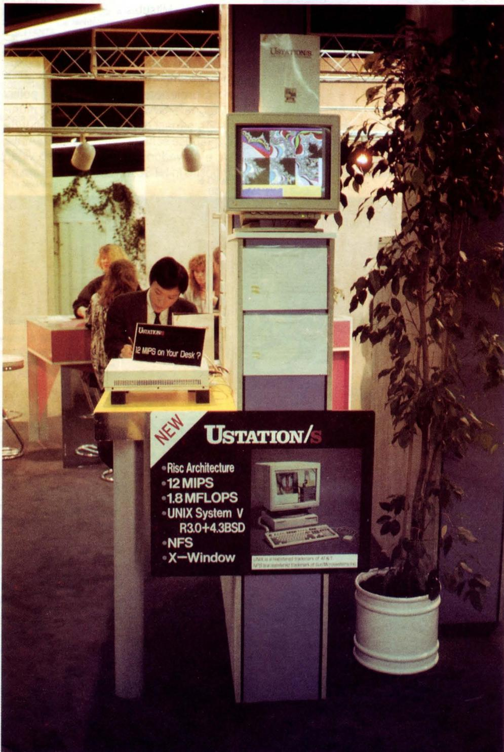
Le nuove workstation grafiche sono ormai fornite con monitor a colori di tipo Trinitron. Ne è un esempio la Ustation, dotata di processore RISC per una capacità di elaborazione di 12 MIPS. A video la generazione in tempo reale di diversi Mandelbrot.
