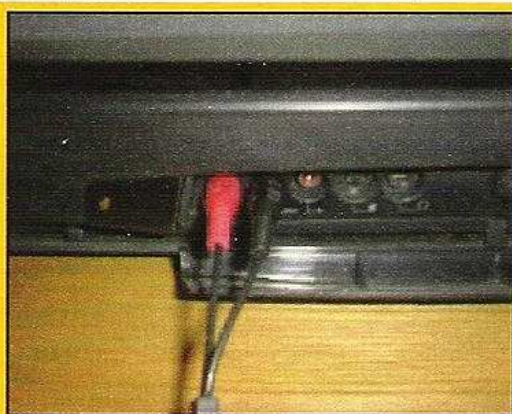
Podłączenie do telewizora nie sprawia żadnych kłopotów, możesz użyć np. wtyków Cinch
