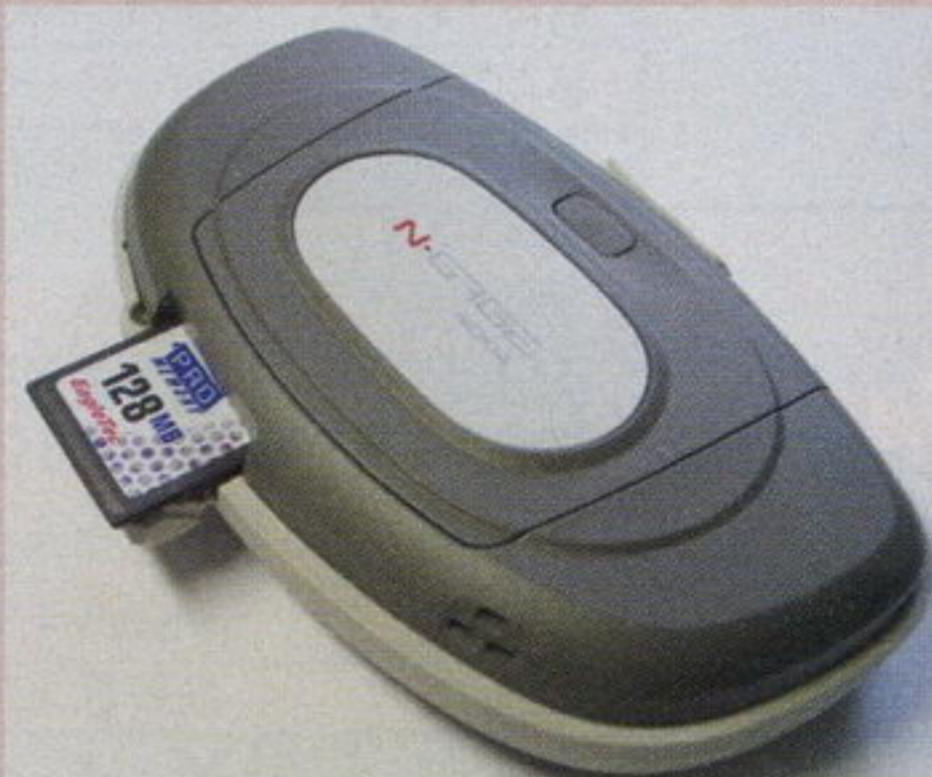
▲MMC卡带插槽改在了主机底部,可以更方便地更换卡带。
