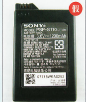
▲组装电池多为厚层标签，印刷模糊，除此以外，如果购买的是日版主机，是绝不会出现印有中文的电池的，因此也可以作为辨别依据。
