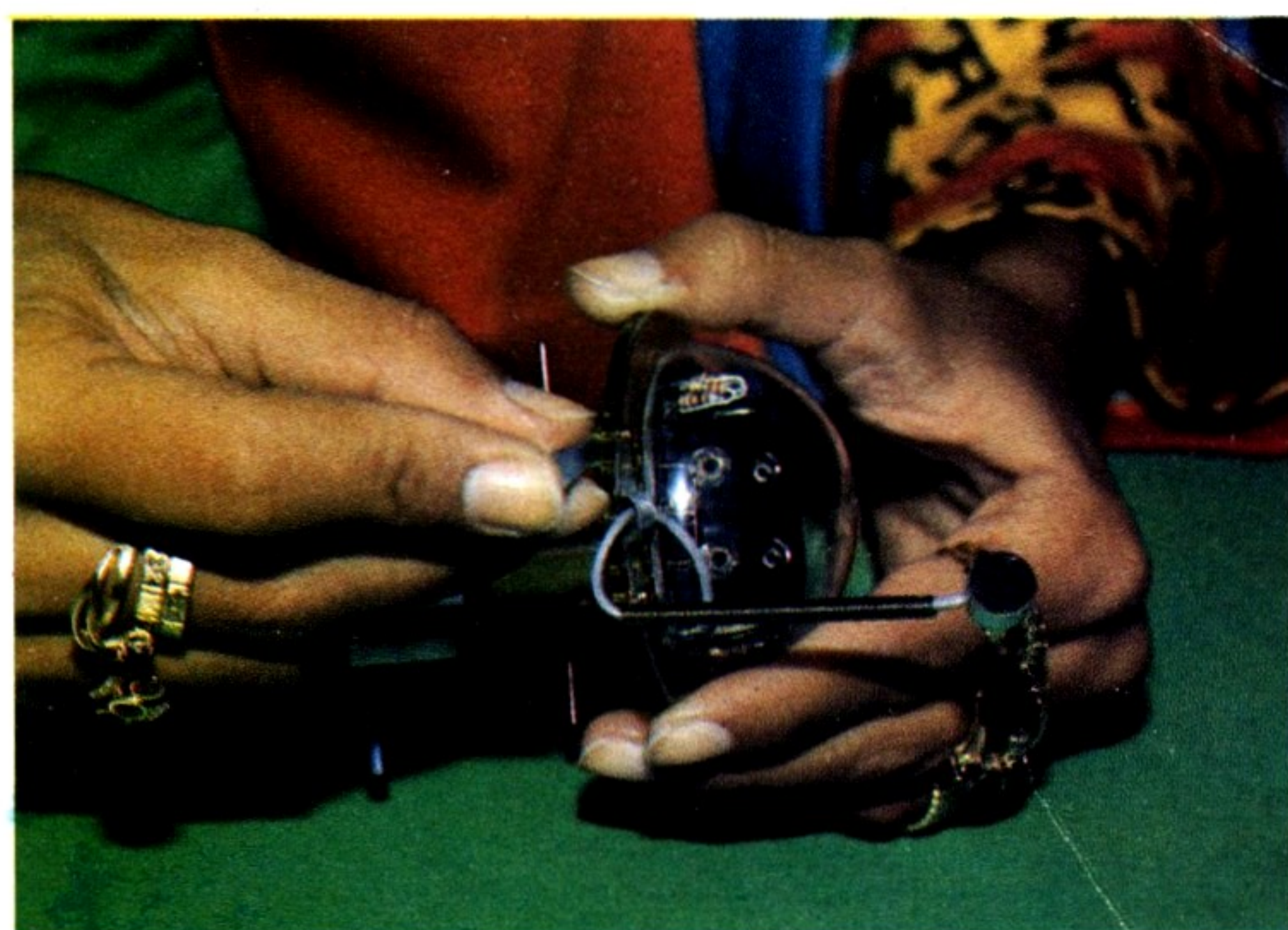
7 - L'elettronica è stata fissata, così come il sostegno elastico della capsula microfonica e la cupoletta trasparente che ricopre la «testa» di Monkey. Non rimane che fissare i bulloncini con la piccola chiave inglese fornita nella scatola di montaggio.
