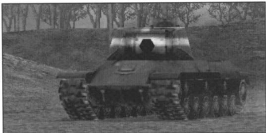
JS-IIでは操縦手席の前面装甲がほぼ垂直に近くなっていたうえに操縦手用のバイザーがドイツ軍に狙い撃ちされたので、前面装甲版を再設計して全面的に傾斜装甲に変更したものがJS-II Mである。搭載砲も同口径ながら閉鎖機に改良を施したD-25Tに換装し、評判の悪かった照準機の位置にも若干の修正を施した。このため防盾の形状も変化している。JS-II Mの122mm砲は1000mで126mmの装甲を打ち抜く力があり、前面装甲100mmのティーガーIを充分撃破する能力を備えていた。
