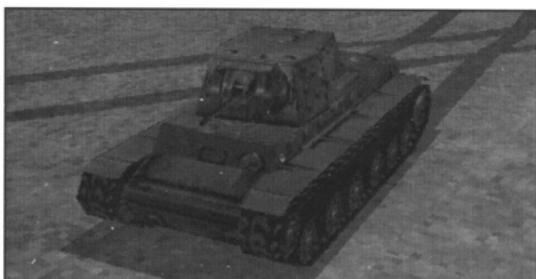
KV戦車はそれまでの多砲塔戦車に代わって敵防御地点の突破や歩兵支援を目的とする重戦車として1939年に開発された。その使用目的から重装甲・強火力が求められた結果、速度に関して遅いことは否めないが、幅広の履帯とトーションバー・サスペンションを装備したことにより、走行性能自体は悪くない。
