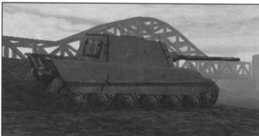
ヤクトティーガーはティーガーIIの車体を利用した駆逐戦車で、開発自体は1943年初頭に始まっているが諸々の事情によって生産は遅れ、結果150輌の発注に対して77輌が完成している。搭載砲は128mm砲で、これはほとんど駆逐艦の主砲なみである。この128mm砲は距離2000mで148mm、1000mで230mmの装甲を撃ち抜くことが可能であった。ちなみにソ連軍が大戦末期に投入したJS-IIIの最大装甲厚が230mmである。従って正面から1対1で撃ち合った場合JS-IIIに勝ち目はなかった（JS-IIIは1000mで126mmを撃ち抜くことが可能）。また装甲については戦闘室前面で250mmに達し、これまた巡洋艦なみであった。当然ながら当時の連合軍の戦車ではほとんど正面からの撃破は不可能である。しかしこれだけ強力な駆逐戦車ではあったが機動力の無さはティーガーII譲りで、迂回して後側面を突かれると砲塔のない悲しさであっけなく撃破される運命にあった。
