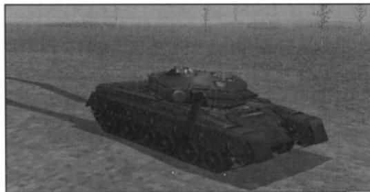
T-80戦車はT-64、T-72戦車の後継車として開発されたソビエト・ロシア軍の主力戦車である。形状的にこの3タイプは非常に近いものがあり、西側諸国では今や標準装備となった複合装甲は使われていない。その代わりT-80戦車にはリアクティブアーマーと呼ばれる外着けの装甲が施されている。リアクティブアーマーとはもともとイスラエル軍によって考案されたもので、四角形の小さなパネルをいくつも繋ぎあわせたものを装甲表面に装着したものだ。それぞれのパネルには爆発物が仕込まれており、HEAT弾などが命中した際にその爆発力でHEAT弾の熱を散らして主装甲に及ぼす影響を減じる効果がある。T-80戦車ではこのパネルがおよそ200個ほど装着されているが、T-80の型によって大きさや形が異なるリアクティブアーマーが見受けられる。
