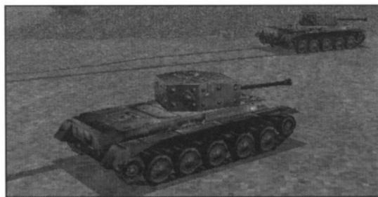
クロムウェルは巡航戦車の流れを汲んで開発された中戦車で、速度が早いだけで装甲が薄く、武装も貧弱であったクルセイダー巡航戦車の後継車として期待された。開発当初、クロムウェルの搭載エンジンはロールスロイス製のミーティアエンジン（スピットファイア戦闘機用のマーリンエンジンと同じもの）が予定されていたが、ロールスロイス社では生産が追いつかないためローバー社で生産することになった。このためにエンジンのみ生産が遅れたため、その間の繋ぎとして登場したのが同じ車体を利用したセントー戦車である。セントー戦車はリバティエンジンを搭載したが（このためクロムウェルはA27M、セントー戦車はA27Lと区別される）、ミーティアエンジンに換装することもできるように設計されていた。しかしほんたー戦車はシャーマン中戦車と性能比較試験を行った結果、最高速度以外では大きく劣り、後にエンジンを換装してクロムウェルMk.Vに改修されるか訓練用として用いられることになった。
