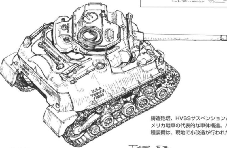
铸造砲塔、HVSSサスペンションと、当時のアメリカ戦車の代表的な車体構造。ハッチなど各種装備は、現地で小改造が行われたようだ。
