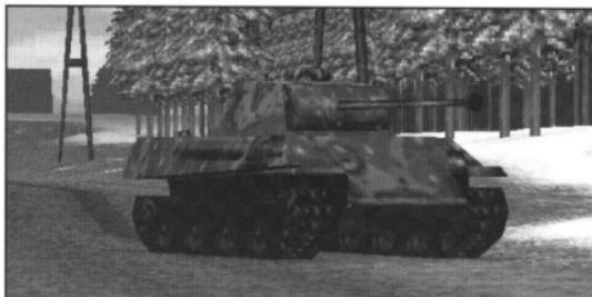
パンターA型はD型の改修に終始したため、外見上の変更は後回しにされた。そこで基本形状の改修に力を入れたのがG型である。主な変更点としては側面上部装甲を厚くする一方で車体下面の装甲を薄くし、この合理性の追求によって防御力アップを図りながら重量の増加を防いでいる。G型は生産途中でも細かい改修が隨時行われ、その中でも後期タイプは防盾がテーパー付きになったり、転輪が鋼製になるなどの変更があった。パンターG型は3126輌生産され、連合軍を大いに苦しめた。
