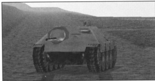
ヘツツァーは駆逐戦車に分類され、敵戦車の撃破をその主任務とした。ヘツツァーのベースとなったのは大戦初期にドイツ軍がチエコより接收した38(t)戦車であるが、実際には車台をそのまま使うのではなく、転輪を大型化するなど手を加えている。小型・軽量でありながら強力な75mm砲を搭載し、終戦までに2584輌生産された。終戦までの僅か1年間でこれだけ生産出来たのは、もともと生産していた経験があること構造が比較的簡単なこと、そしてなによりヒトラー自らが最優先での生産を命じたことによる。しかし、生産コストも含めて確かに優秀な駆逐戦車ではあったが、ペース車体が38(t)戦車というだけあって車内は極端に狭く、戦闘中の乗員の苦労は相当なものがあったらしい。車高の低さと傾斜装甲は防御力の面ではプラスだが、性能はそれだけで決まるものではない。とはいっても、ヘツツァーは大戦末期の苦しい防御戦を見事に戦い抜いた名車といえる。そのためかヘツツァーは戦後になってもチエコやイスラエルで使用されている。
