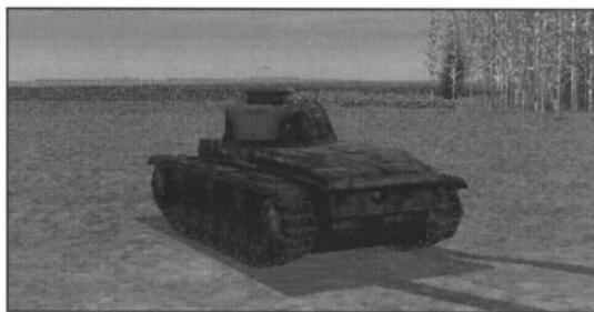
III号戦車はドイツ軍の主力中戦車として開発されたが、戦争が開始されるやその搭載砲の威力の低さが問題となった。もともと用兵側は50mm砲を搭載するように要求していたが、兵器局側は歩兵が使用している37mm対戦車砲との共用を考えていた。この意見対立の結果、将来的に50mm砲の搭載が可能なマウントにする代わりに当面は37mm砲を搭載することで決着がつく。しかしその後37mm砲は明らかに威力不足であることが判明したため、結局F型以降は50mm砲に換装されることになった。III号戦車は足回りについても開発当初から難航し、A～D型までは実質的には試作車輛として主にサスペンションなどの改良を繰り返している（A～Dまでの合計生産量は70輌である）。その後ようやくE型にいたって量産可能となり、ポーランド戦にはごく少数が参加した。しかし、このIII号戦車で培われたトーションバーサスペンションの技術はその後ほとんどのドイツ戦車に活かされたことを考えると、この努力は決して無駄ではなかった。
