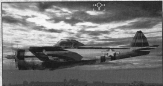
2300馬力の大出力エンジンに、12.7mm機銃×8、900kg爆弾×1、ロケット弾×10の戦闘機離れした重武装でドイツ軍機を圧倒したP-47。地上攻撃にも、その大火力はいかんなく発揮された。
