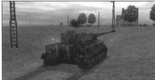
ティーガーI戦車はもともとIV号戦車の後継車として支援中戦車の役割をもって開発が始まった。しかし独ソ開戦によって主力戦車がIV号戦車になるにおよび、対戦車戦闘に主眼を置いた重戦車として新たに設計しなおされた。ティーガーIの開発にあたってはヘンシェル社とボルシェ社の2社が競合したが、車体はヘンシェル社、砲塔はボルシェ社のものが採用され、ヘンシェル社製の車体を若干修正してティーガーIが完成した。ティーガーIの車体形状はそれまでのドイツ戦車の流れを汲む直線を主体とした無骨なスタイルで、事実上この戦車がドイツ独自の思想で開発した最後の戦車となつた。ちなみに砲塔側面の装甲は鋼板を馬蹄形に曲げた1枚板である。後期型の特徴としては内部にゴムを仕込んだ鋼製転輪になったこと、転輪の配置の変更、砲塔天蓋の装甲強化、マズルブレーキの小型化などが挙げられる。
