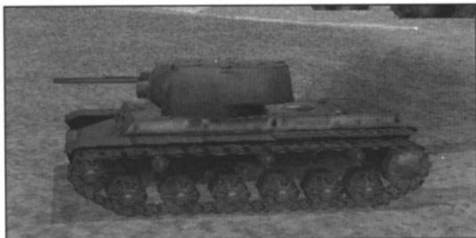
KV-I C型はKV-Iの改良型で、主な変更点は搭載砲が41.5口径のZis-5になったことと、砲塔の装甲を厚くした新設計の鋳造タイプになった点である。また、この時期にそれまでのKV-Iもこの新しい鋳造砲塔に換装された。
