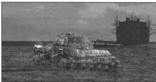
ティーガーIIはティーガーIの後継車として開発されたが外観形状はまったく別物で、むしろT-34の影響を強く受けたパンターに似ている。そして形状だけでなく、試作のみに終わったパンターF型とのバーツやエンジンの共通化が図られている。これらを見る限り、ドイツ軍としては中・重戦車を可能な限り共通化して生産の合理化を図り、用途に応じて使い分けることを考えていました。しかし大戦後半の状況はそれを許さず、空襲による工場の生産力低下などによって終戦までに生産されたティーガーIIはわずか489輌にすぎない。この489輌のうち初期生産分50輌がいわゆるボルシェ砲塔を搭載している。ボルシェ砲塔とヘンシェル砲塔の大きな違いは防盾にあり、ボルシェ砲塔の防盾では防盾下部に命中弾を受けた場合に跳弾した砲弾が車体装甲上部に被害を及ぼすのがわかったため、急遽生産中止になっている。
