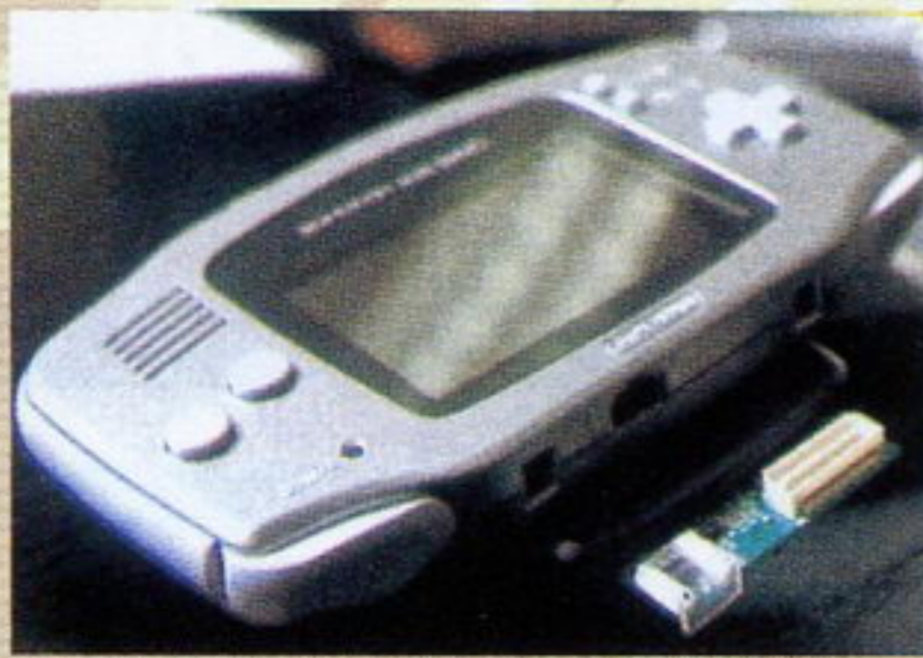
▲这是开发中的样本，在那个透明的四角形部分里就装着感光器。
