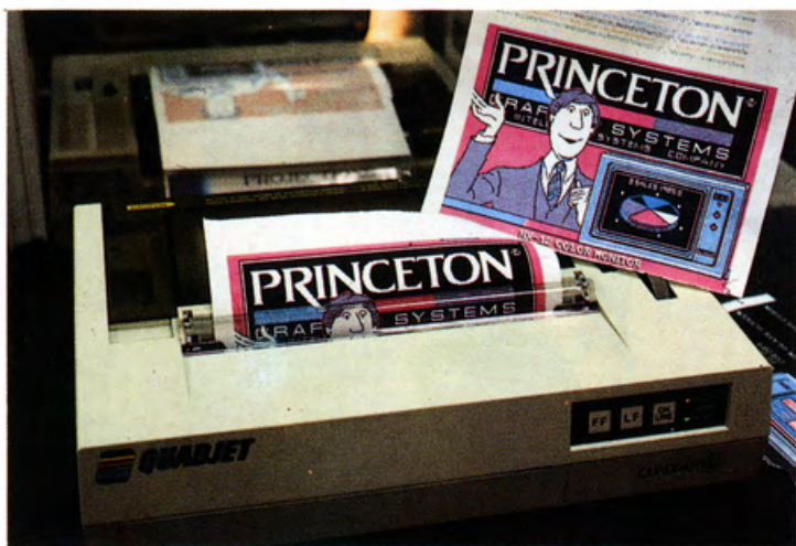
Foto 2 - Dall'America, della CANON, la QUADJET, con una risoluzione di colore sui pieni davvero invidiabile. Ormai le stampanti a getto d'inchiostro hanno superato tutte le problematiche inerenti all'intasamento degli ugelli e quindi sono diventate di estrema duttilità. Il prezzo previsto entro i 2 milioni.
