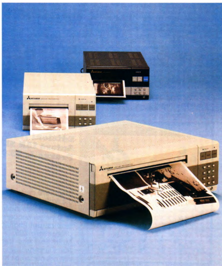
Foto 3 - Tre VIDEO COPY PROCESSOR della MITSUBISHI. Questa ditta si sta specializzando nella produzione di termo-stampanti utilizzate per l'Hard Copy del video, o di segnali provenienti da altre fonti quali telecamere o strumenti elettronici, il tutto a colori o in bianco e nero a seconda delle esigenze.
