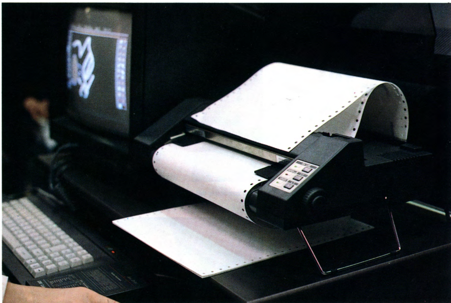
5 - Una validissima stampante grafica, la Super RITEMAN C. Da notare l'originale sostegno incorporato che permette l'alloggiamento dei moduli continui.
