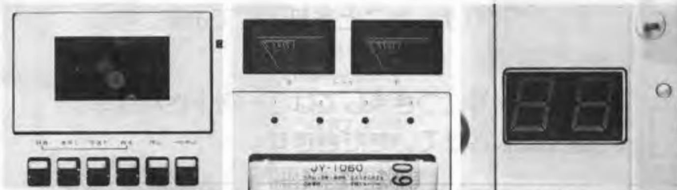
カンカローポケット式カセット装置。ステレオレベルメーター内蔵。コイン枚数2桁表示。
