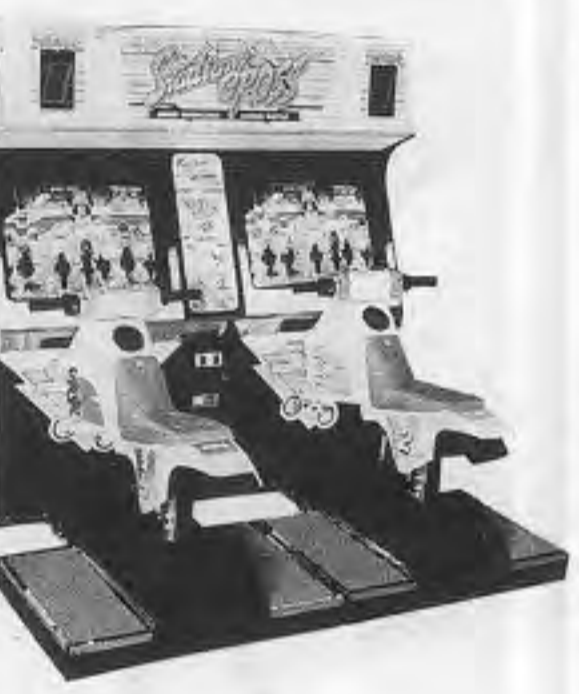
スタジアムクロス 同社「システムマルチ32」使用第1弾となるTV体感/バイプレーズゲーム。通信機能により最大8人まで同時プレイ可能。定価170万円。【セガ社】No.431
