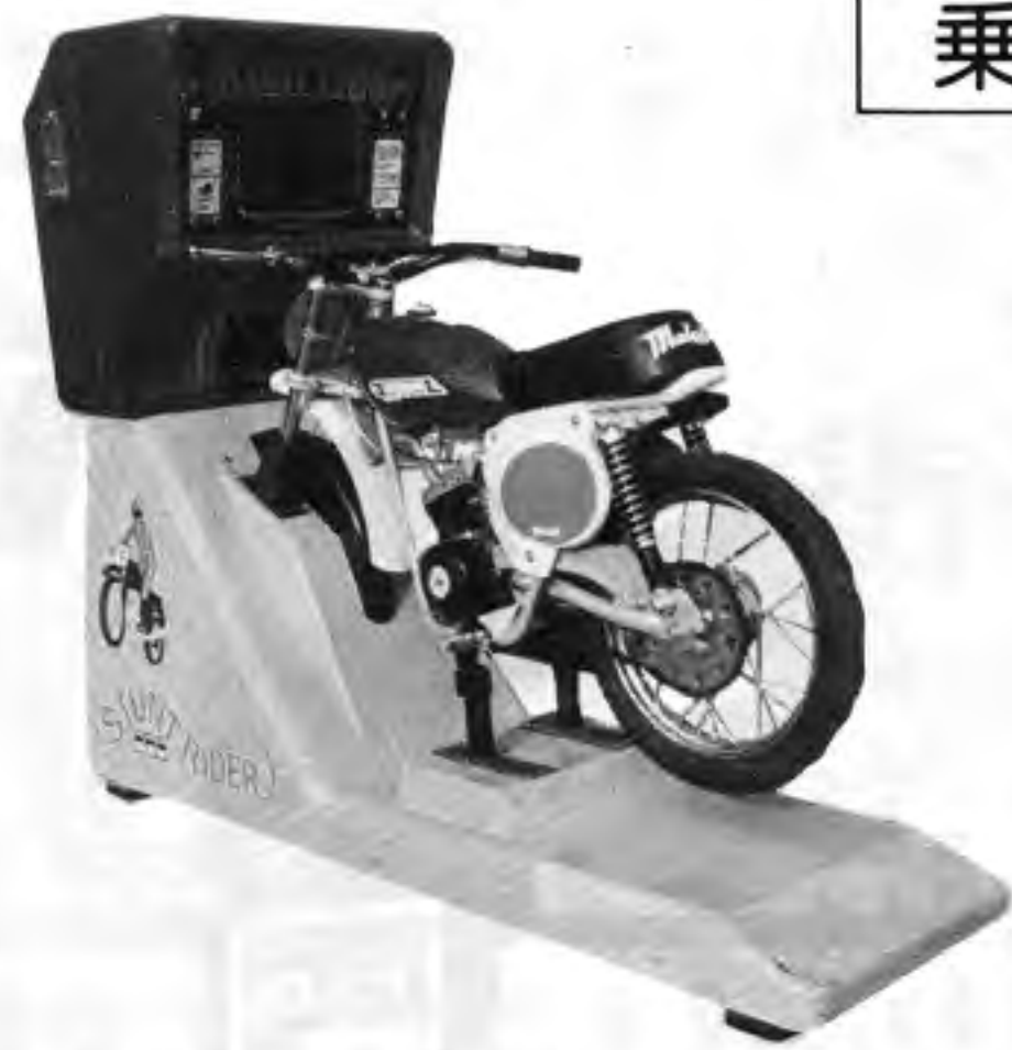
ウィタカー・ブラザーズ社の「スタント・ライダー」。前輪は実際に回転するほか、前面にTVモニターがあつて走路(コース)が示されている。
