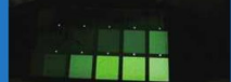
▲这种在纯黑界面下都显示黑绿色的屏幕即为油污屏,购机时一定要注意。
