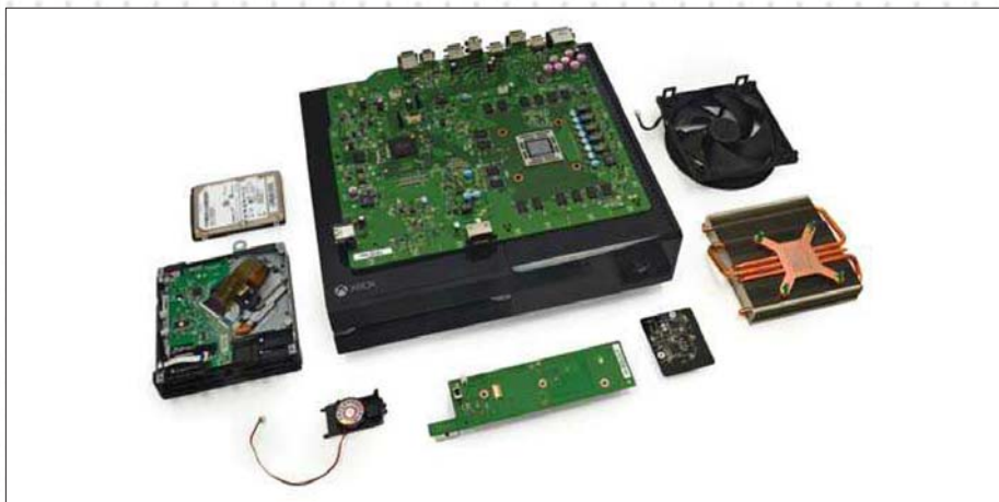
▲根据 iFixit 的拆机报告, Xbox One 的内部构造并不复杂,生产的工艺要求相对较低。其中内存与主处理器是成本最高的零部件。微软在想尽办法保持性能不变的前提下大幅降低成本。从图中也可以看到,散热系统占了很大的空间。降低到 20 纳米工艺后,可以在这方面大幅缩减尺寸。
