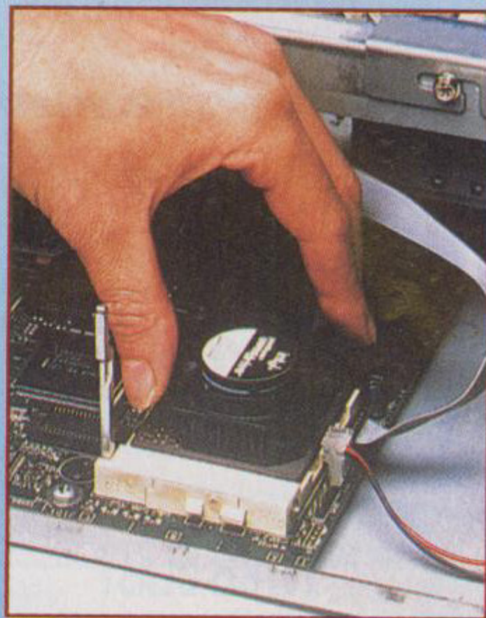
Ein Handgriff, und die neue Overdrive-Platine mit Pentium-MMX-Chip steckt im Pentium-Sockel
