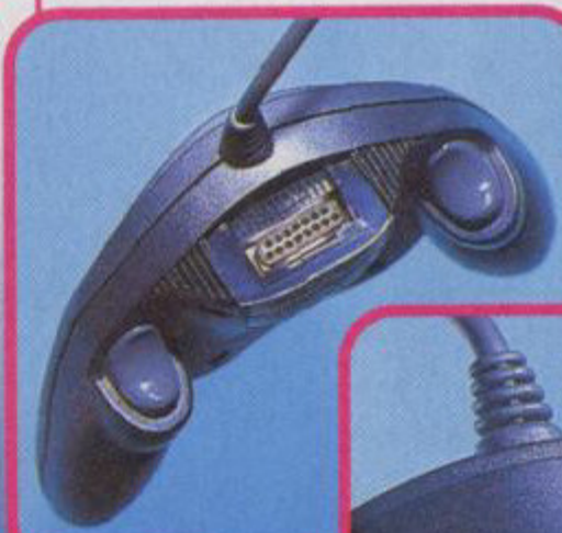
Das Sidewinder Gamepad hat auf der Rückseite zwei Feuerknöpfe und eine Extra-Buchse. Dort kannst Du ein zweites Gamepad anschließen
