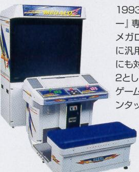
1993年、『バーチャファイター』専用筐体としてスーパー・メガロ50の名で登場。のちに汎用化され、15KHz出力にも対応するスーパー・メガロ2として発売。15/24KHzのゲームが同時搭載可能で、ワンタッチで切り替えることができる。
