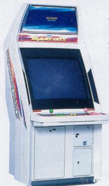
1996年、「バーチャファイター3」と同時に発売。MODE L3に対応させるため、セガ汎用筐体で初めてハイレゾリューション(31KHz)のモニターを採用。画面サイズはこれまでと変わらぬ29インチだったが、よりフラットになったのも特徴。本体重量は101キロとやや大型化。
