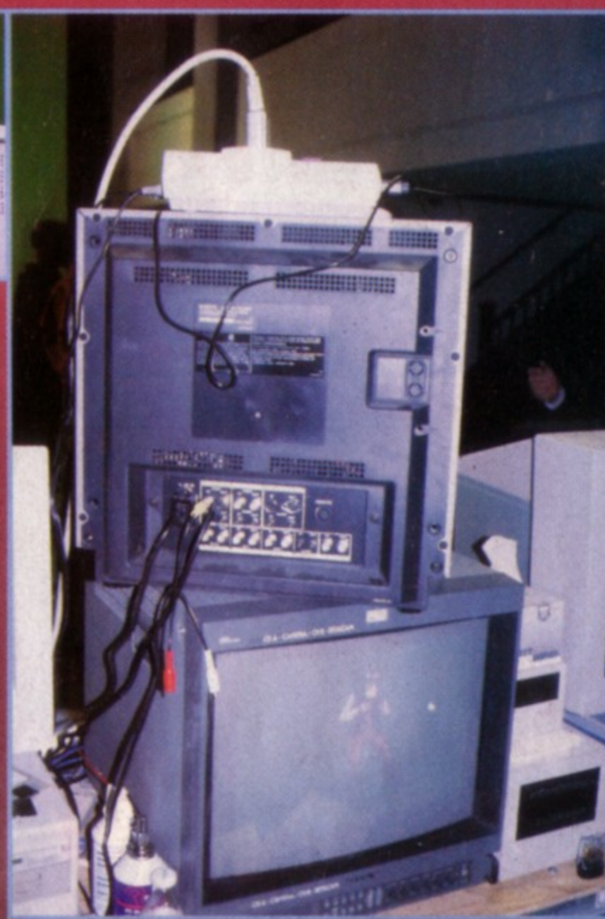
Sur l'un des moniteurs de contrôle, on peut apercevoir une console Super NES avec une cartouche très spéciale: elle contient des composants électroniques qui permettent d'afficher directement sur la Super NES l'image filmée! Le personnage est ensuite immédiatement placé dans le décor original du jeu. On voit alors s'il y a des conflits d'affichage dus aux couleurs. Encore un gain de temps non négligeable... En observant bien la photo, vous pourrez distinguer le cascadeur sur le moniteur, en bas.
