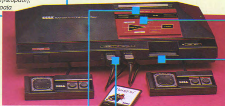
Ενσωματωμένος πίνακας λειτουργιών, με ενδεικτικά LED λειτουργίας και ξεχωριστά πλήκτρα για PAUSE και RESET
