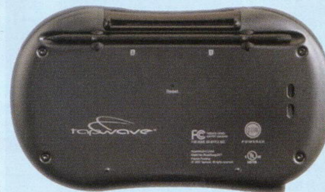
▲ zodiac 背面图, 可以很清楚地看到一般 PDA 的标准配置——铁笔, 因为 PDA 屏幕都是触摸屏式的, 有了铁笔就可以很方便地在屏幕上点击来操作软件或游戏, 当然用来进行手写输入也是很重要的 (尤其是中文输入)。铁笔上面就是两个扩展槽。
