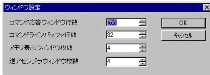
ダイアログ ボックスで、各ウィンドウの属性を指定し、「OK」ボタンを押してください。
