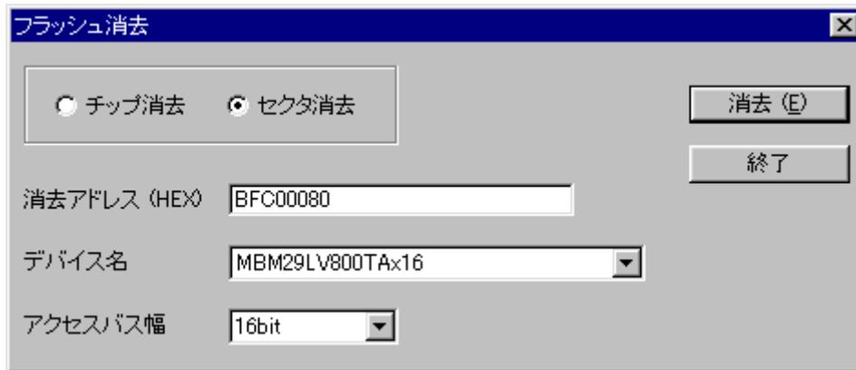
ダイアログボックスで消去アドレス、デバイス名、アクセスバス幅を指定して、「消去」ボタンを押してください。
