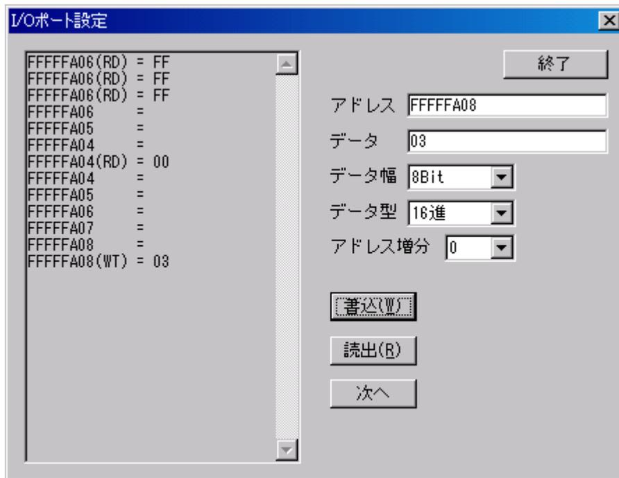
ダイアログ ボックスで、変更する I/O ポートの アドレス(16 進数)、データ、データ幅、データ型 アドレス増分を指定し、「書込」または「読出」ボタンを押してください。
