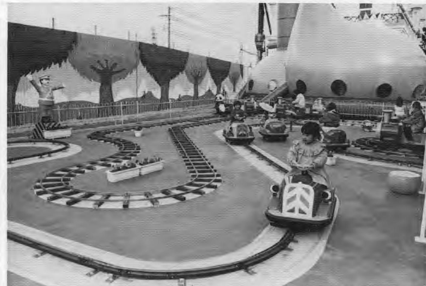
朝日エンジニアリング製レール走行式乗物機「ファミリートレイン」(2本レール)と、同社がバッテリーカー「チビ丸」を、1本のセンターレール上を自動的に走るレール走行式に改造した「ファミリーカー」(写真手前)
