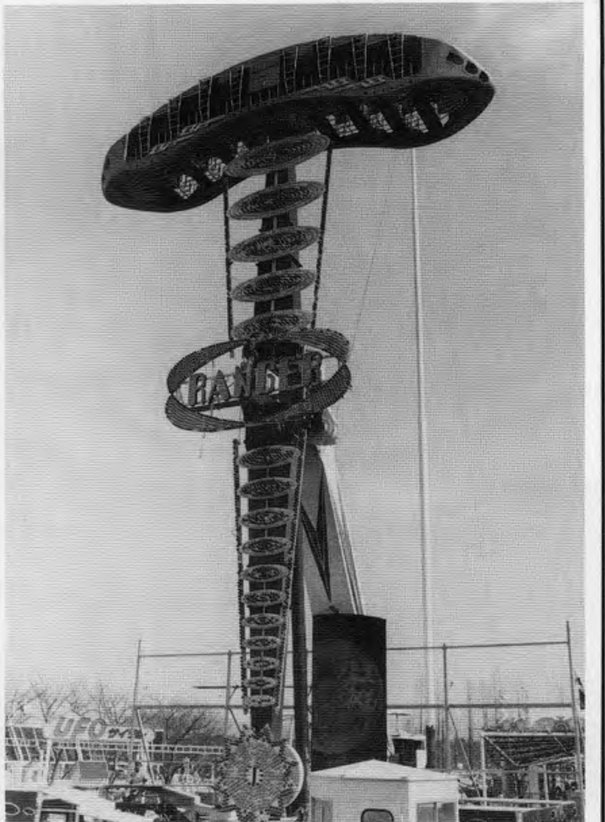
西独フス社製「レンジャー」は乗物の船体が垂直宙返りを行なう絶叫マシン。独特の油圧コントロール機構によるダイナミックな動きが特徴。4月末営業運転開始で写真は試運転中のもの
