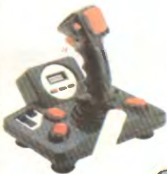
SV 125 Superboard 6 Fire 10 Mikrostryków AutoFire Cyfrowy wyświetlacz czasu Sygnal dźwiękowy Przełącznik dla leworęcznych Drażek lotniczy
