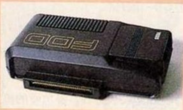
↑ 為了配合主機連接而設計的二英寸軟式磁碟機。
