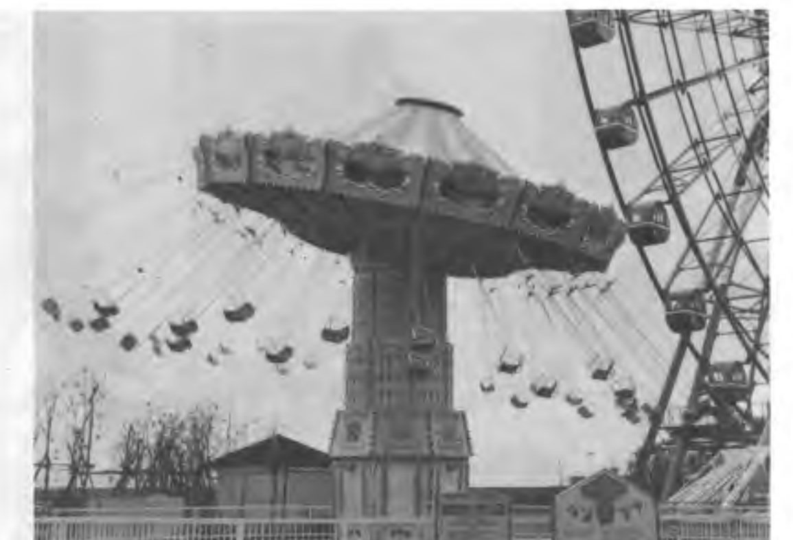
大型高速回転ブランコ「ウェーブスインガー」。回転直径は11mから21mまで変化する。
