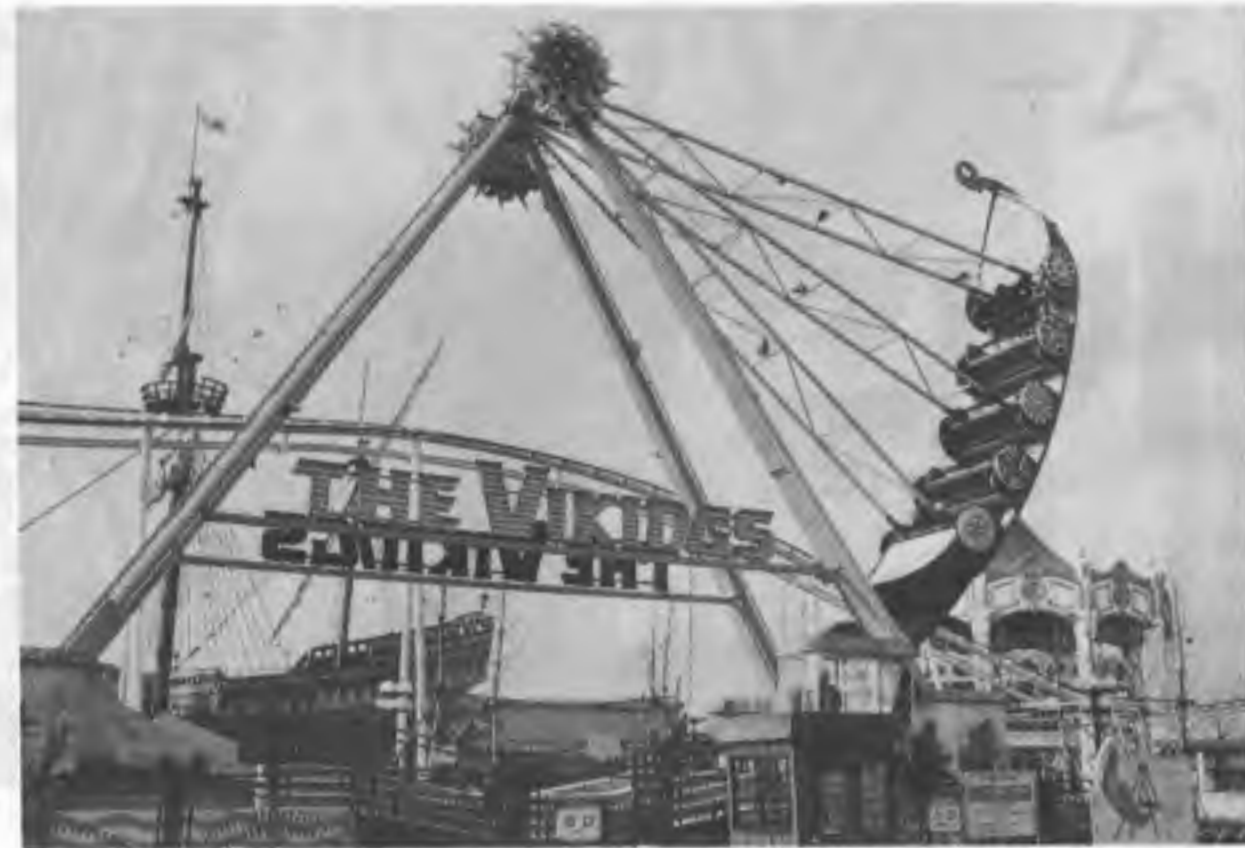
最大振角度64度の振り運動をする「バイキング」。下降時に乗客は一瞬の無重力感。
