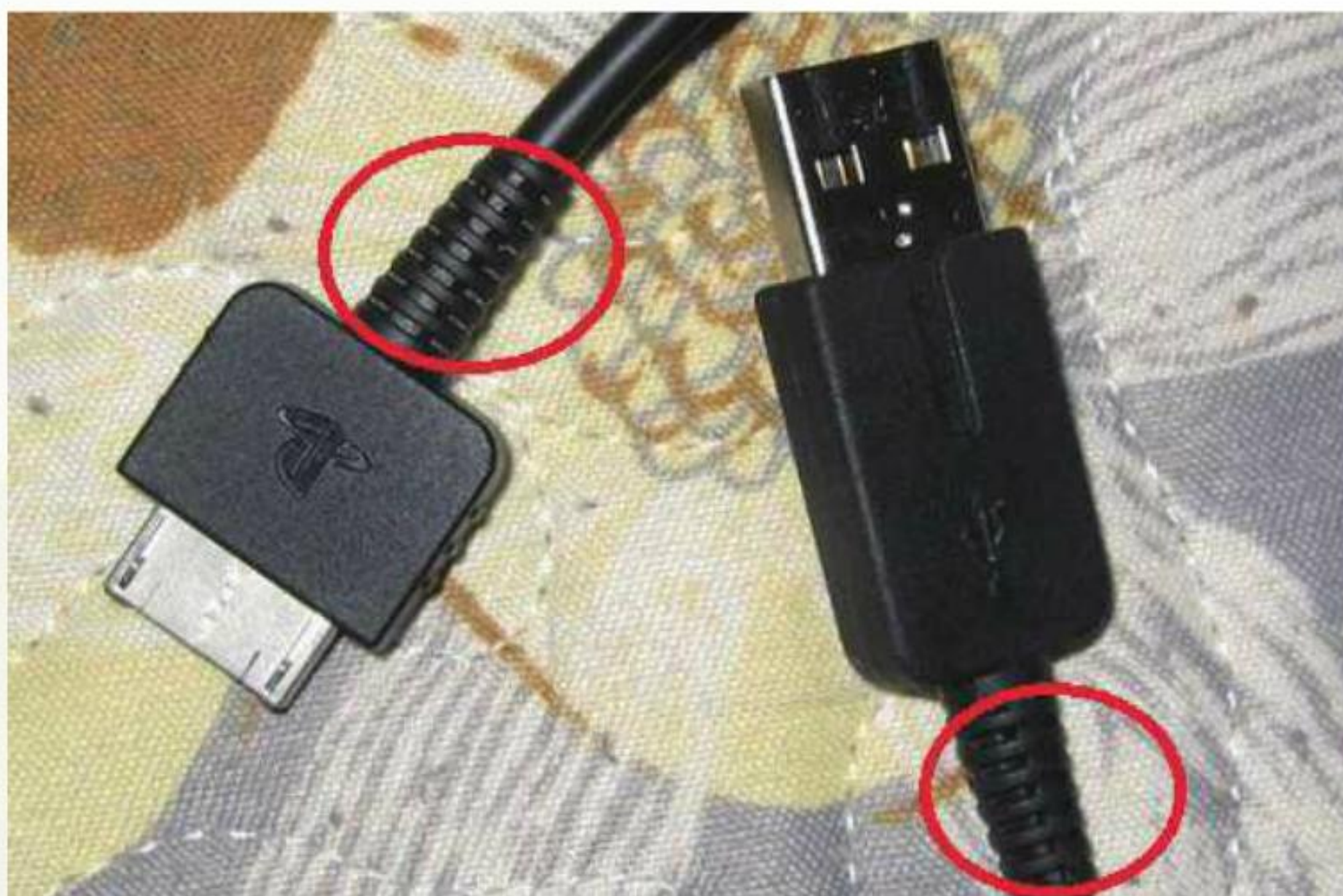
▲原装USB线末端的保护区很长，而组装USB线保护区只有短短的两三节。
