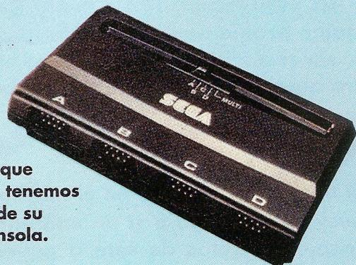
El dispositivo se inserta entre el puerto de expansión de la Mega Drive y el conector de la Mega CD, de forma que puede interferir los datos mientras estos se dirigen del lector CD hacia la consola. Por lo tanto, emplea la misma técnica que los diseñados para las consolas convencionales, pero varía el lugar de inserción, ya que el origen de los datos no es un cartucho, sino un disco compacto.
