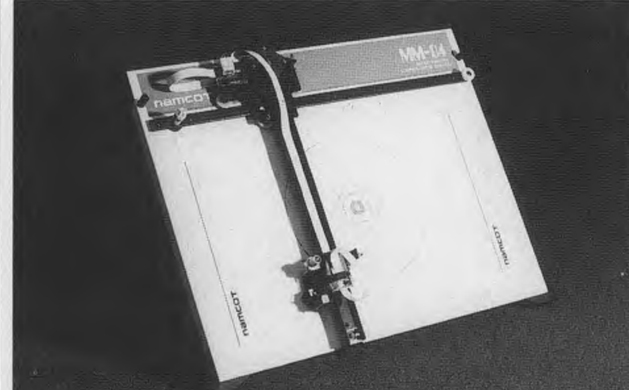
ナムコ「メカトロマスターシリーズ」のうち写真上はステップングモーター制御セット、下はシーケンス制御セット
