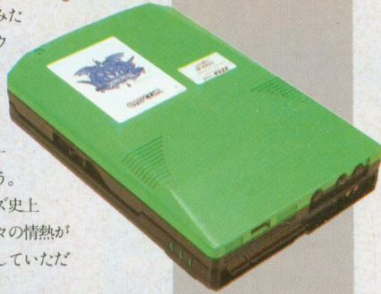
▲「ヴァンパイア」のゲーム基板。「CPシステムII」というカプコンのマザーボード上で動作している
