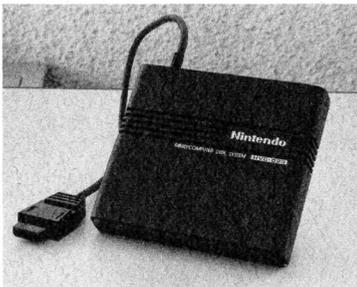
▲これがファミリーコンピュータ本体に取り付ける「RAMアダプタ」だ。中には今までのROMカートリッジにかわるRAMとフロッピーを取り扱うためのソフト「ファミリーコンピュータDOS(ドスと読む)」が入っている。
