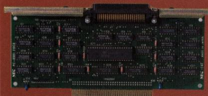
PC-8801 ● 8インチ2D (1MB) ドライブ用インターフェイスカード。サブCPUを介さずメインCPUとコンビを組むDMAコントローラが直接FDコントローラを制御する仕様であった。
