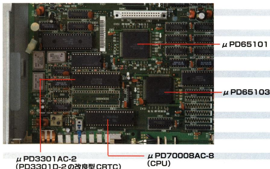
PC-8801MH/FH以降の88はCPUとしてµPD780C-1をCMOS化して高クロック駆動に耐えられるように設計変更したµPD70008AC-8が搭載され、従来の2倍速に当たる8MHzで動作するように改良された。ただし、周辺デバイスや拡張スロットの互換性を保つため、メモリやCPU等をオーバルバスに閉じこめ、従来互換バスとブリッジチップ兼メモリコントローラであるµPD65103経由で接続する構成となっている。また、グラフィックの高速化にともないµPD65101が専用コントローラとして搭載されているのも大きな特徴である。
