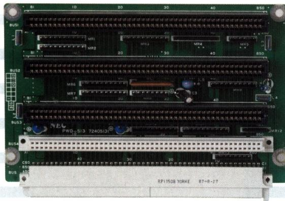
PC-88VAでは、PC-9801シリーズ標準のCバススロットが用いられている。ただし、BIOSが異なるためBIOS ROMの載った98用拡張ボードは使えず、そうでないものも専用のデバイスドライバを用意する必要があった。
