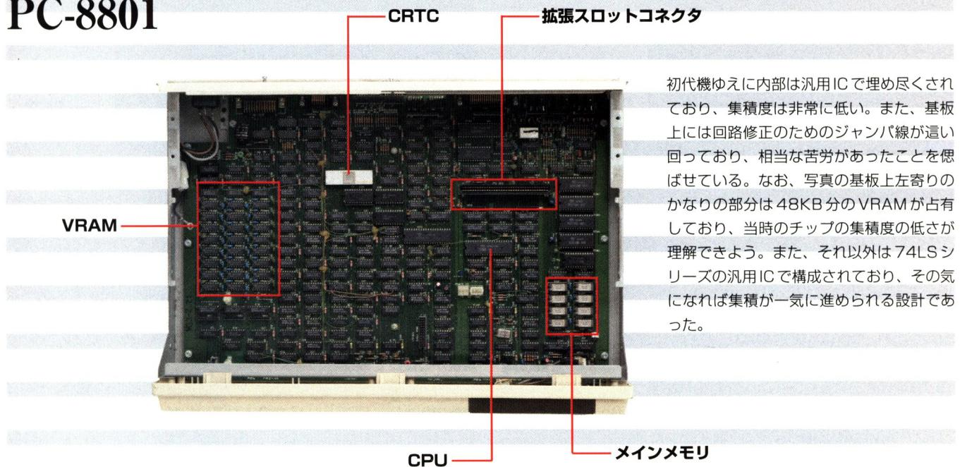
初代機ゆえに内部は汎用ICで埋め尽くされており、集積度は非常に低い。また、基板上には回路修正のためのジャンパ線が這い回っており、相当な苦労があったことを想いさせる。なお、写真の基板上左寄りのかなりの部分は48KB分のVRAMが占有しており、当時のチップの集積度の低さが理解できよう。また、それ以外は74LSシリーズの汎用ICで構成されており、その気になれば集積が一気に進められる設計であった。
