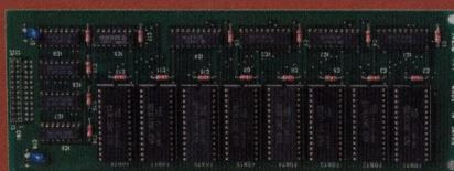
初代PC-8801ではオプション、しかも第一水準のみであった漢字ROMは、2世代目のPC-8801mk IIで標準搭載となり、4世代目のPC-8801mk II MR以降、2HDドライブ搭載機については第二水準も標準搭載されるようになった。JIS第二水準漢字の標準搭載が遅れたのは、2
