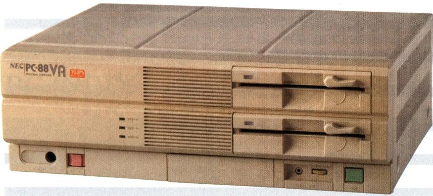
シリーズ中わずか2世代3モデルしか存在しない16bitマシンの初代モデル。筐体デザインそのものは従来シリーズのそれを踏襲しているが、CPUの16bit化とグラフィック機能の大幅強化にともない内部構造が飛躍的に複雑化した。それ受けて、同時期のPC-9801シリーズデスクトップモデル並みの背の高い筐体が新規設計された。高発熱デバイスの増加でエアフローの改善が求められ、各部の吸気スリットが増やされている点と、FDDが上下2段に取り付けられている点が目を引く。なお、拡張スロットは98系と同じCバスが採用されているが、完全互換ではない。
