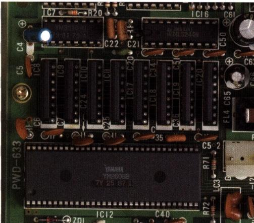
PC-8801FA／MAに初搭載されたFM音源チップ「YM2608B (OPNA)」は従来の「YM2203C」の上位互換チップである。FMが6音に倍増し、SSGに代えてリズム音源が6音搭載となったほか、4BitのADPCMが1音使用可能という、極めて強力な仕様であった。リズム音源はチップに内蔵されたサンプリング音を再生するもので、ADPCMともども決して高音質ではなかったが、FM音源では再現不可能な厚い音が出せるというメリットがあった。
