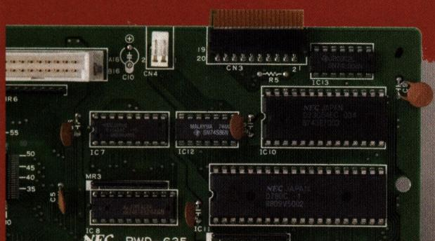
プロジェクトの互換性保持のためもあり、FD コントローラ制御用 CPU として μPD780C-1 が最初から最後まで搭載され続けた。
