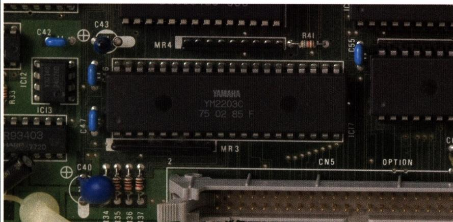
PC-8801mk II SRで初搭載されて以来、PC-98D0まで長く搭載された「YM2203C(OPN)」は4オペレータで同時発音数がFM3音+SSG3音+ノイズ1音という構成のモノラルFMシンセサイザーチップである。FM音源としての表現力はそれほど高くはなかったものの、複数の音源を内蔵していて使い勝手がよく、それまでのビープ音やPSG(SSG)音源のみによるものとは比較にならないほど魅力的な音楽再生が可能であった。
