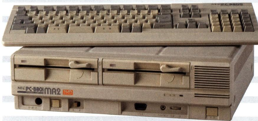
末期に登場した上位機種。同一のシャーシを流用しているため、一見PC-8801FAと区別がつきにくいが、上位機ゆえにFDDは2HD対応となっており、大容量メモリ搭載や辞書ROMの搭載など、内容的にはきっちりと差別化が図られている。また、この機種ではROM BASICのモード切り替えはキーボード上のPCキーを用いたソフトウェアメニューによるメモリスイッチ操作に変更されており、前面の切り替えスイッチが廃止され、これに代わって9ピンD-SUB端子によるマウスポートが新設されている。
