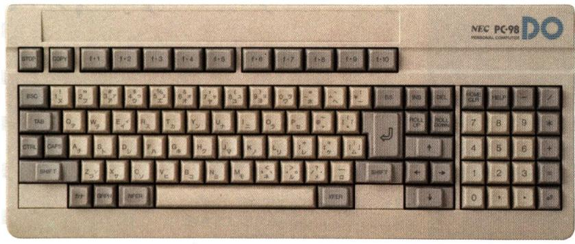
PC-98DOのキーボードは当時のPC-9800シリーズのうち、PC-9801VM11等と共に、[XF1]～[XF5]キーを持たないタイプのキーボードを基本としている。キースイッチはタッチが秀逸なことで定評のあったNEC自社製で、このキーボードもその恩恵で非常に良好なキータッチを実現していた。ただし他の98用とは異なり、内蔵コントローラのプログラムに変更が加えられていて、88モード時に[GRAPH]キーが[PC]キーとして機能するようになっていた。このため、PC-98DO/DO+ではこのキーボードなしでは88のメモリスイッチが操作できなかった。
