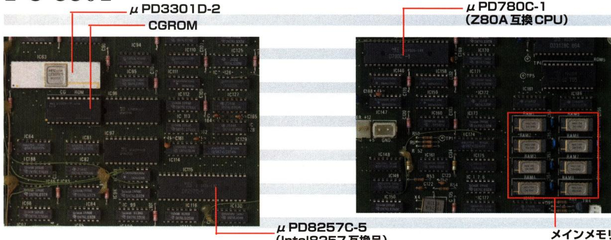
初代PC-8801は汎用チップ満載であったが、その中でも異彩を放っていたのが、PC-8001から継承したCRTCのµPD3301D-2である。このチップはキャラクタジェネレータも内蔵していて、直近にフォントデータを格納したCG ROMが実装されている。また、このチップは別途DMAコントローラも必要で、汎用の8257相当品に接続されている。
