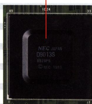
この時期のPC-9801シリーズを象徴するのがこれらのチップ群である。μ PD9012～9014は元来ラップトップ機のために開発されたカスタムLSIで、上位機に搭載されたFGC以外の98固有機能がほぼ全て集積されている。これに対しV30(μ PD70116C-10)はインテル8086互換CPUで、名機PC-9801VM2に搭載されて名をはせた。
