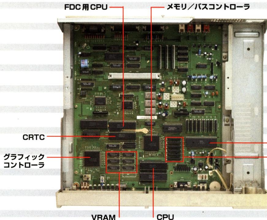
PC-8801FAの1世代あとの機種であるが、チップの集積度がさらに向上し、一段とすっきりしたレイアウトになっているのがわかる。そのわりに部品点数が減って見えないのは、FAと異なりサブCPUを含むFDC回りとJIS第2水準漢字ROM、それにワープロ機である「文豪」から移植された「かな漢字変換辞書データROM」がオンボード搭載されているためである。また、この機種ではI/Oポートがマザーボード直接実装に戻っている。
