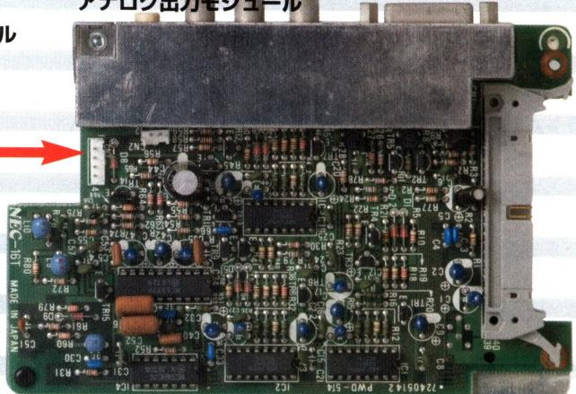
実際に筐体を開くと、この写真のように、メイン基板の上にメイン基板に積みきれなかったサウンド機能やFDコントローラとそのCPU等を実装したサブ基板が重ねられている。さらにその上にRGBやAV出力コネクタをまとめたアナログ出力モジュールが接続されていた。この構成は、当然ながら非常に高コストであった。
