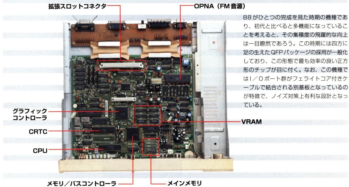
88がひとつの完成を見た時期の機種であり、初代と比べると多機能になっていることを考えると、その集積度の飛躍的な向上は一目瞭然であろう。この時期には四方に足の生えたQFPパッケージの採用が一般化しており、この形態で最も効率の良い正方形のチップが目に付く。なお、この機種ではI/Oポート群がフェライトコア付きケーブルで結合される別基板となっているのが特徴で、ノイズ対策上有利な設計となっている。
