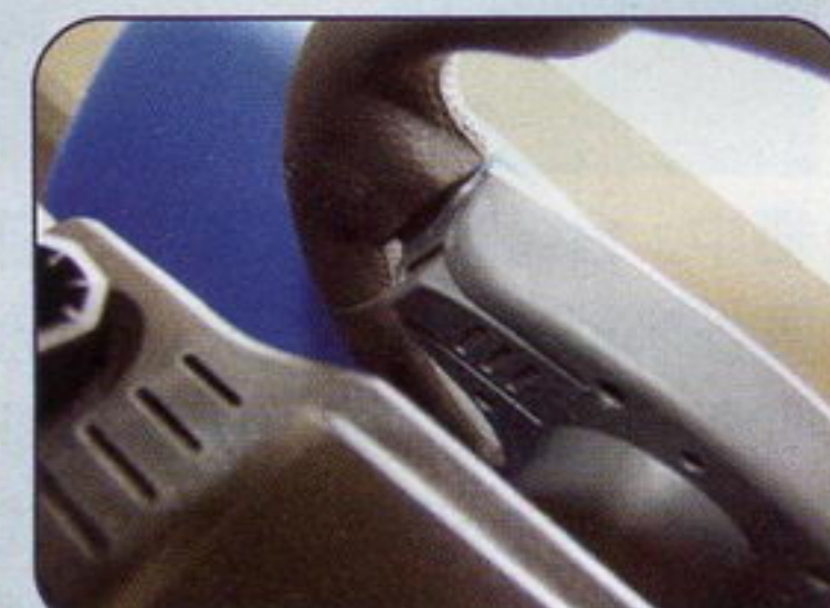
▲方向盘后面左右两侧还各有一个拨片换挡装置，这是F1方程式赛车独有的。
