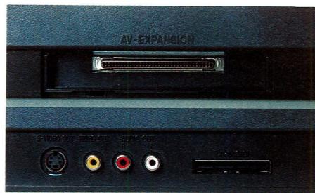
▲3DO本体のどれかの端子に、パワーPCを搭載したアダプタを装着することで、現在の32ビットの3DOを、64ビットマシンにパワーアップすることができる。
