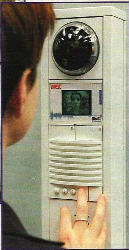
A oto elektroniczny strażnik. Teraz twój dom będzie zabezpieczony przed intruzami. Jeśli komputer uzna, że wyglądasz i mówisz inaczej, niż on zapamiętał – nie wpuści cię do środka!
