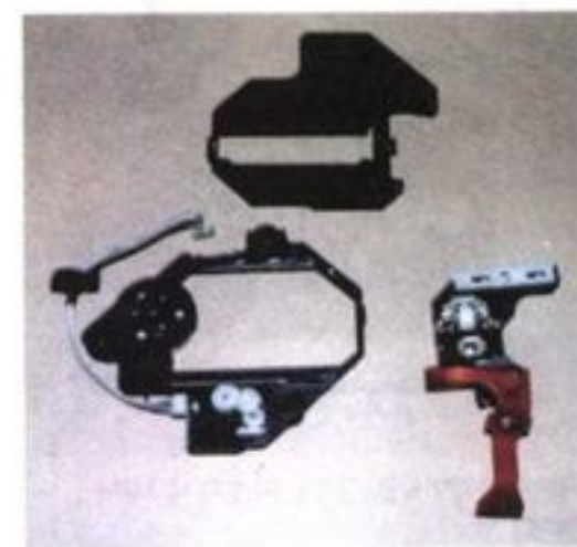
▲레이저 픽업을 분해한 모습. 왼쪽의 동그런 부분이 모터이고 노란 필름 케이스가 달려 있는 부분이 가장 핵심적인 부분이다
