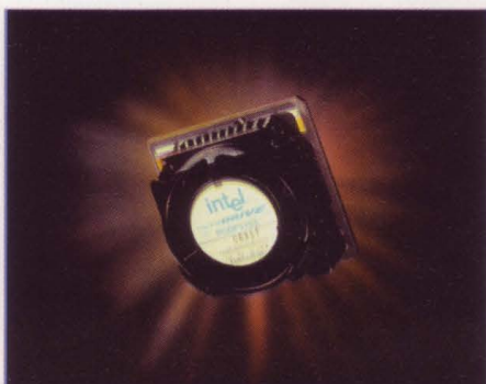
Il chip del Pentium Overdrive è integrato da una miniventola di raffreddamento. Se la ventola salta, il chip passa a Underdrive
