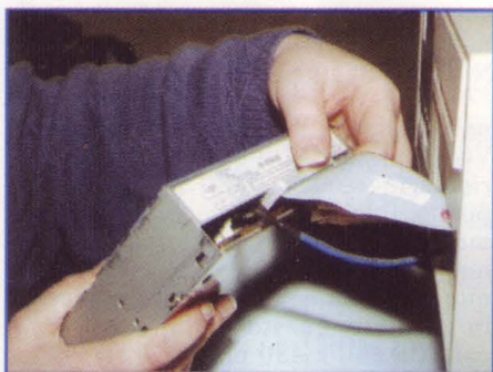
E' più facile collegare i cavi prima di aver inserito il nuovo CD nella case
