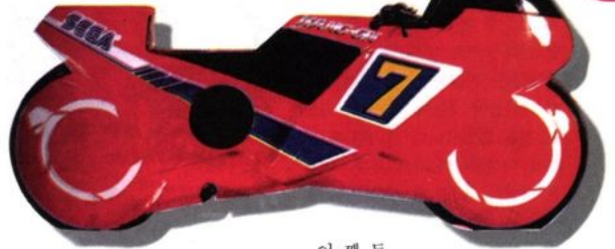
『행은』(세가/85년)- 화면 안에서의 행동이 이 바이크에 반영되지 않고 바이크를 움직이는 것에 의해 게임을 조작한다. 즉 이 바이크는 거대한 조이스틱이다
