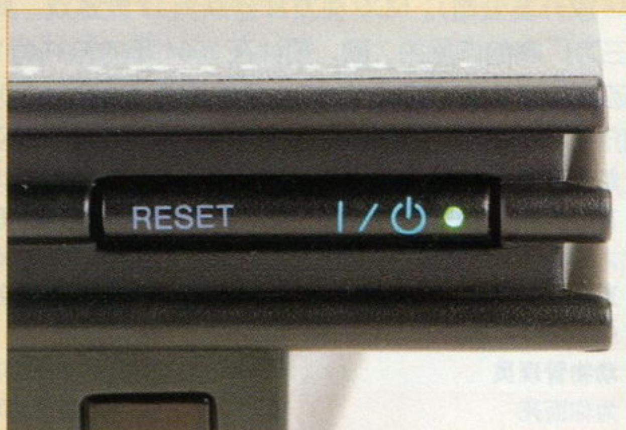
复位键：超薄PS2取消了电源开关，保留了RESET键，也就是只要主机一接上电源，主机就进入了待机状态。
