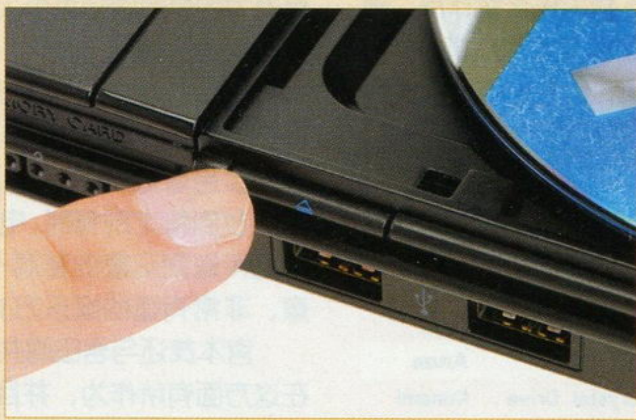
开盖键：与原PS2的“出仓键”有很大的不同，因为超薄PS2的开盖键即使在断电的情况下也可以打开光驱盖，这一设计与PS相似。
