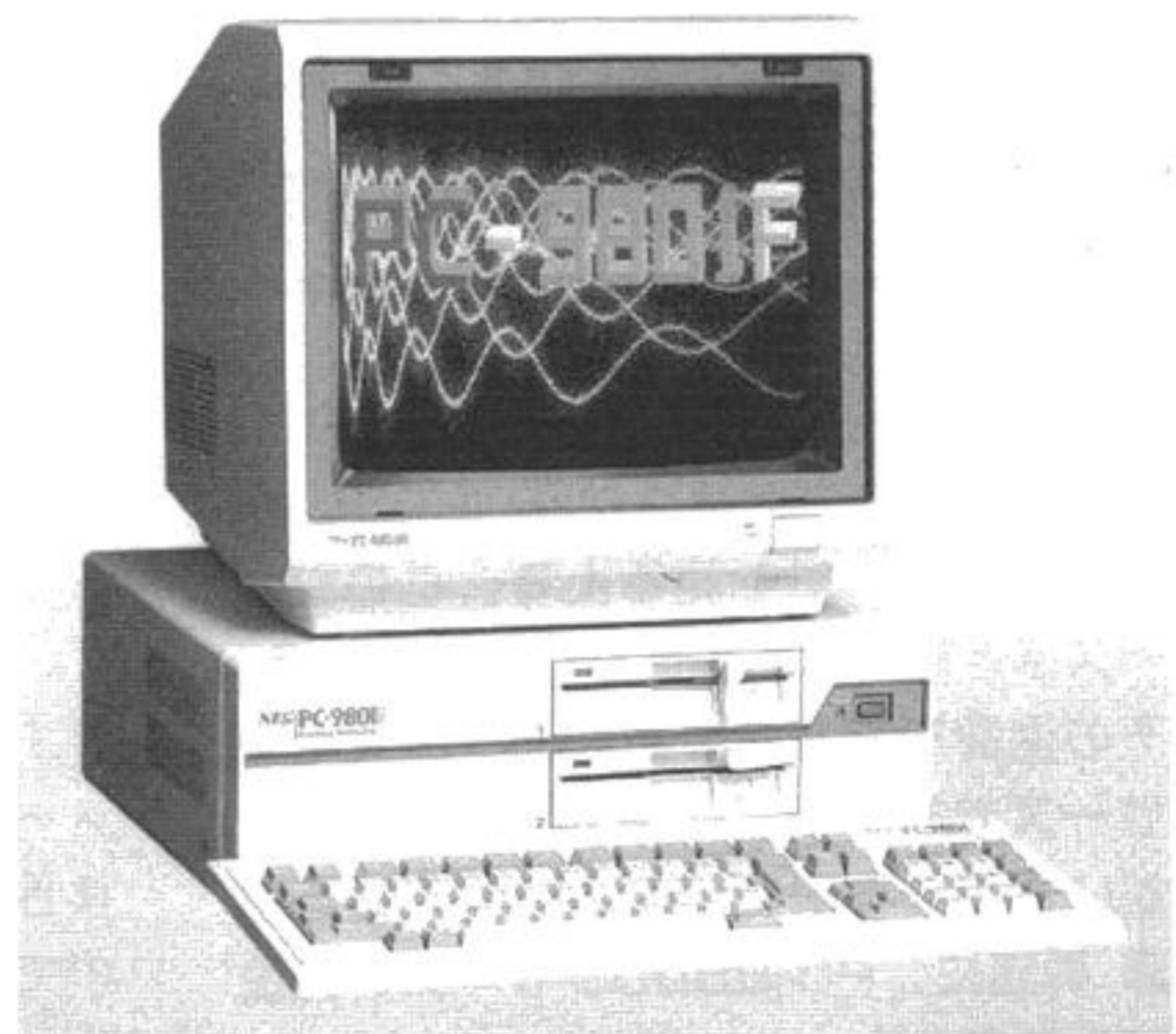
PC-9800シリーズを不動のものにした「PC-9801F」。CPUは8086-2(8MHz)、メモリは128kBだった。640kBのFDDを搭載している。
