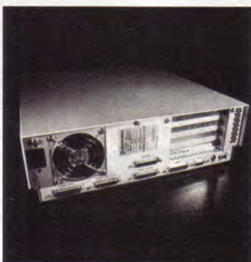
Το πίσω μέρος της A3000. Μεταξύ των άλλων, διακρίνουμε (από αριστερά): Σειριακή θύρα, είσοδο για drive, SCSI port και παράλληλη θύρα. Στο δεξί μέρος, κάτω από τα card slots, είναι μαζεμένοι οι connectors για ηχητικές και ακουστικές συνδέσεις.
