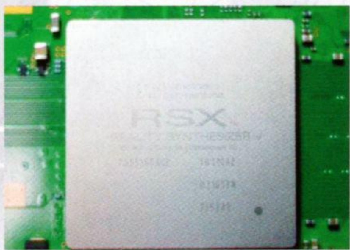
▲新版 PS3 使用了能耗更低的 40 纳米制程 GPU。
