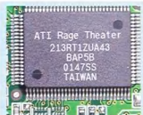
UF-8500 多了一個 ATI Rage Theater 的視訊解碼晶片。
