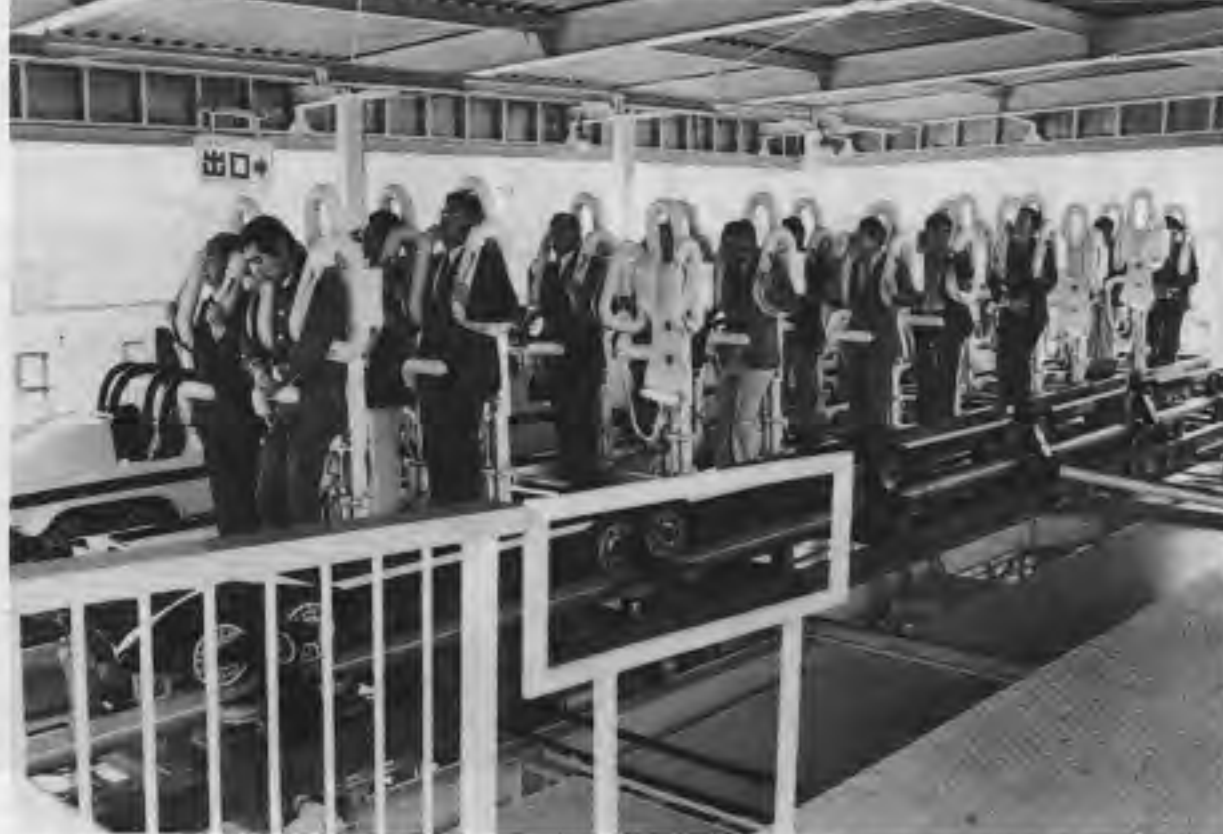
上の写真と同じく、停止位置にある「立席車両」。肩押え、腰押え、サドルと緩衝軸
