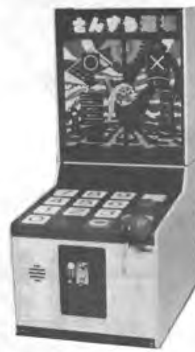
さんずう道場 電卓をゲーム化したもの。パネルに示される算数問題を計算し解答キーをハンマーで叩いていく。腕前に応じら段階の判定。定価66万円。【ナムコ】No163
