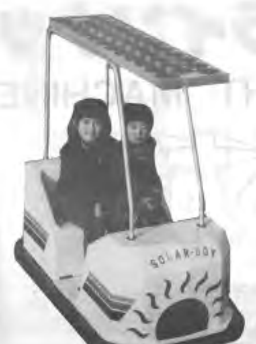
ソーラーボーイ 太陽電池を動力源としたパッチリカー。時速は約4.5km/h、2人乗り。充電が可能なので曇天の日でも走行に影響なし。定価67万円。【真砂工業】No161
