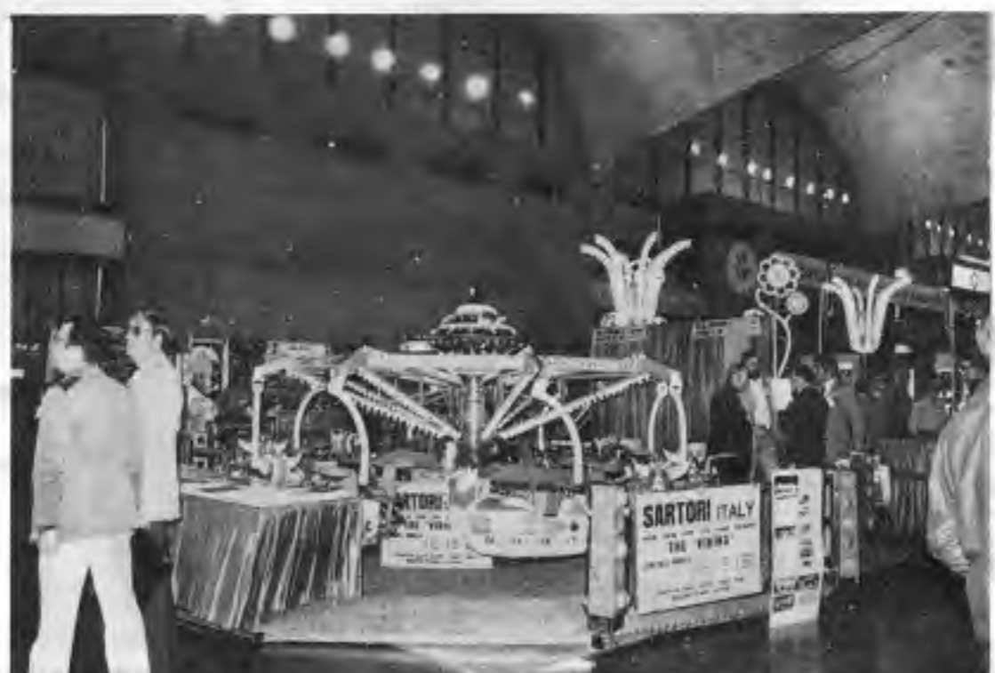
イタリアのサルトリ社から出品された「ザ・バイキング」小さな子ども用ゴンドラが、大きく回転するアームにとりつけられている。
