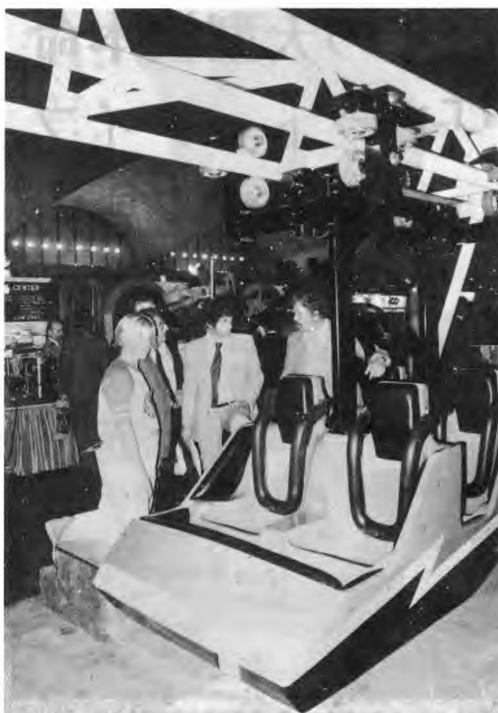
アロー社「サスペンティッド・コースター」の実物見本。ぶら下りの構造がよくわかるが、普通の宙返りでも恐い人は乗れそうもない。
